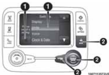
Uconnect 3 mit 5-Zoll-Display, Schaltflächen auf dem Touchscreen und Tasten auf der Blende
