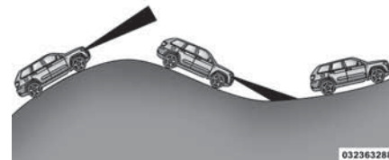
Beispiel für Abstandstempomat (ACC) an Steigungen
