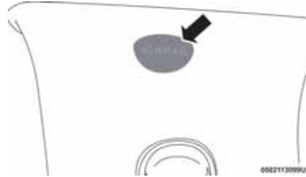
Position der Aufkleber für zusätzliche Seiten-Airbags (SABIC)
