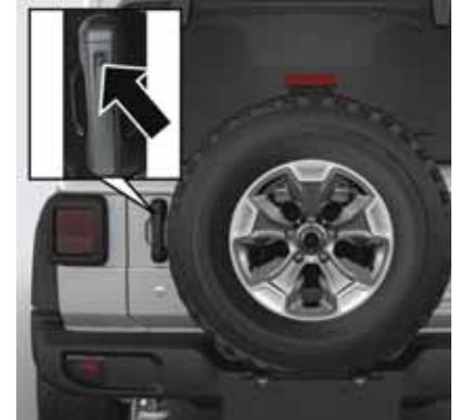
**Position von Heckklappen-Passive Entry**
