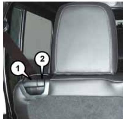
**Lage des Hebels für die hintere Kopfstütze**
