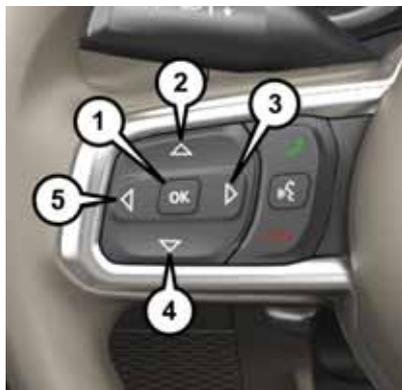
**Steuertasten auf der Kombiinstrumentanzeige**
