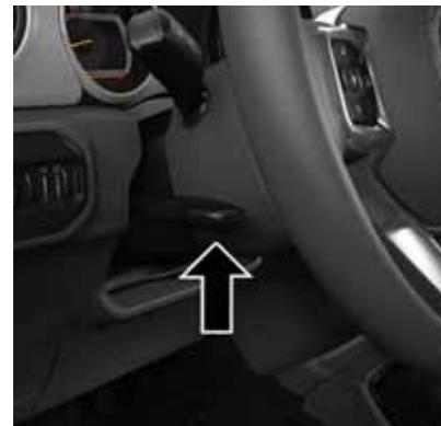
Hebel für höhen-/längenverstellbare Lenksäule
