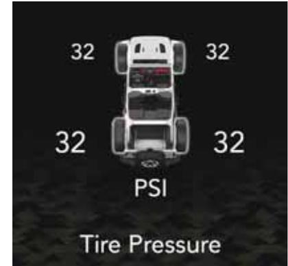
**Display zur Reifendrucküberwachung**
