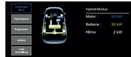
ANMERKUNG Während der Energierückgewinnung beim Abbremsen („eBraking“ oder „eCoasting“) kann der auf dem Display des **Uconnect™**-Systems angezeigte Leistungswert der Hochspannungsbatterie negativ sein.
