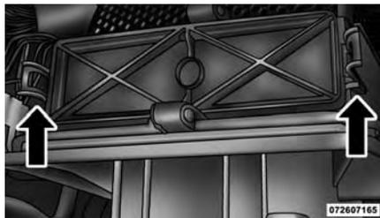
**Austauschen des Luftfilters der Klimaanlage**
