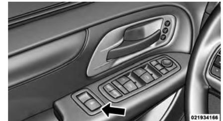
Schalter für die elektrisch betätigten Ausstellfenster zum Öffnen/Schließen
