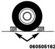
6. Das dem zu wechselnden Rad diagonal gegenüberliegende Rad mit Unterlegkeilen oder Holzklötzen vorn und hinten blockieren. Soll beispielsweise das rechte Vorderrad gewechselt werden, ist das linke Hinterrad zu blockieren.
