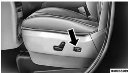
Schalter der elektrisch verstellbaren Lendenwirbelstütze
