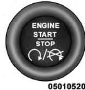
Mit dieser Funktion kann der Fahrer den Zündschalter per Tastendruck betätigen, sofern die Taste START/STOP (Motorstart/-stopp)
