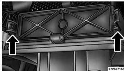
Remplacement du filtre à air de climatisation
