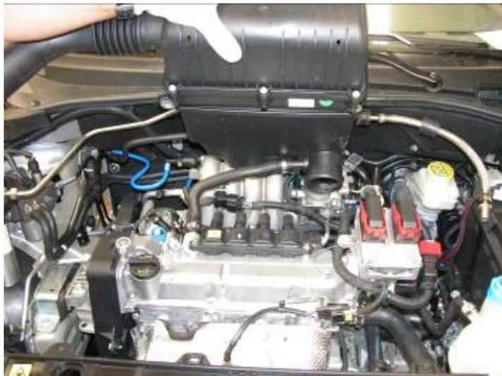
Verificare il numero dello stampo riportato sull' aletta di fissaggio collettore iniettori lato attacco innesto rapido tubazione carburante.
