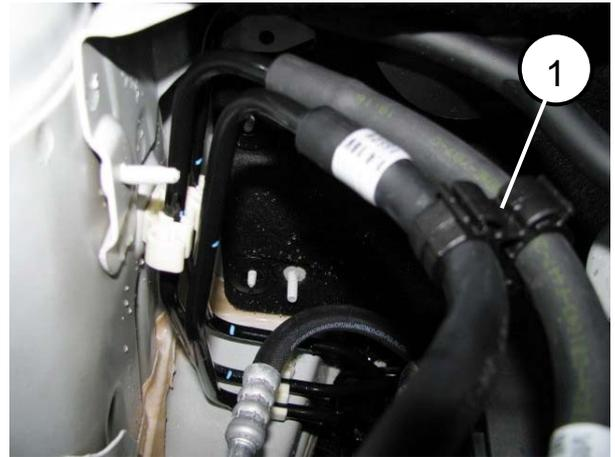
Die korrekte Befestigung der Benzinleitungen (2) in der weißen Klemme (3) an der Strebe prüfen.
